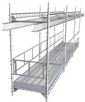
Industri - varv - offshore Hängande ställning Tillåten spirlast 20,0 kN Inplankning: Krokplan, stålplank, aluminiumplank
